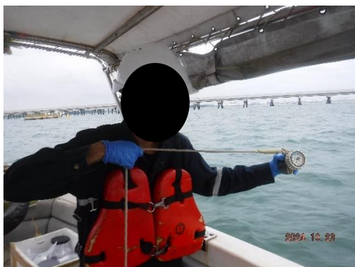
การตรวจวัดระดับความลึกของน้ำทะเล ด้วย Depth Gauge
