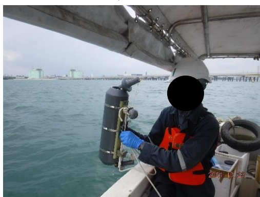
การเก็บตัวอย่างน้ำทะเลด้วยเครื่องมือเก็บตัวอย่าง แบบเทฟลอน
