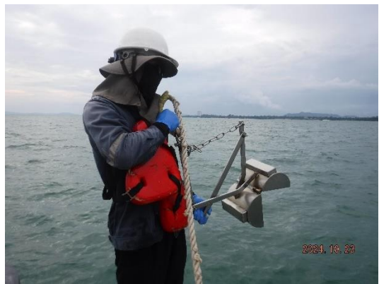
รูปที่ 3-92 การเก็บตัวอย่างสัตว์หน้าดิน (Benthos) ด้วย Petersen Grab Sampler
