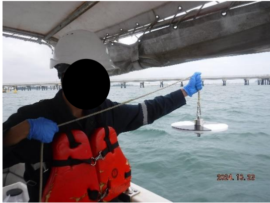
รูปที่ 3-90 การวัดค่าความโปร่งใสด้วย Secchi Disc
